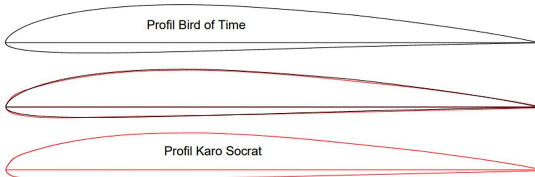
*Bild 76: Die Flügelprofile von Bird of Time und Karo Socrat sind identisch*
